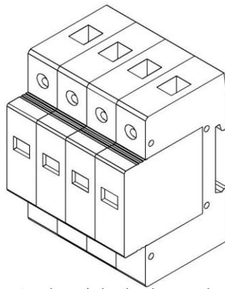
Este es un supresor de picos (protección contra sobre tensiones) destinado a ser instalado de manera accesible y permanente en una instalación eléctrica interior.
